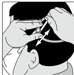
3. Assicurarsi che il respiratore indossato aderisca e risulti confortevole. Se necessario regolare la tensione dell'elastico tirandolo da entrambi i lati della bardatura nucale.
