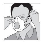
4. Assurez-vous du confort et de l'ajustement du masque. Réglez la tension des brides en les faisant coulisser dans le passant.
